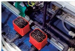
○ 次氯酸钠发生器系统 Sodium hypochlorite generator system
